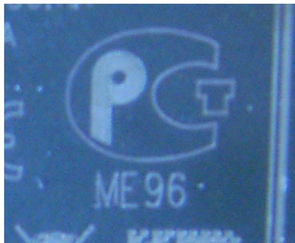
Фото 2. Увеличенные изображения знака соответствия при обязательной сертификации на зарядном устройстве мобильного телефона Nokia 6085
