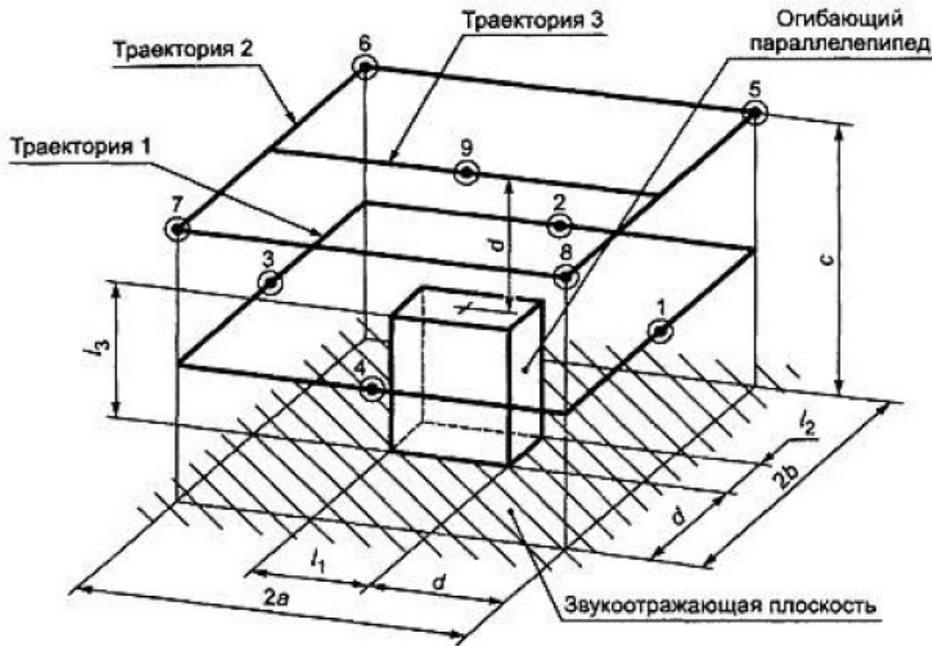
Рис. 1. Измерительная поверхность с девятью точками измерения для усложненного и полу или стене источник шум
