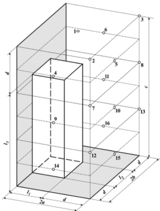
Илл. 1. Измерительная поверхность для высокого источника шума с небольшой площадью опоры, установленного на полу у стены, с шестью точками измерений
