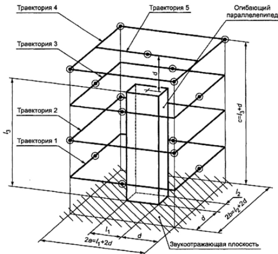
Рис. 5. Пример измерительной поверхности и положений (траекторий) микрофонов для высоких источников шум с небольшой площадью опоры ( $l_1 \leq d$ ,  $l_2 \leq d$ ,  $2d \leq l_3 \leq 5d$ )
