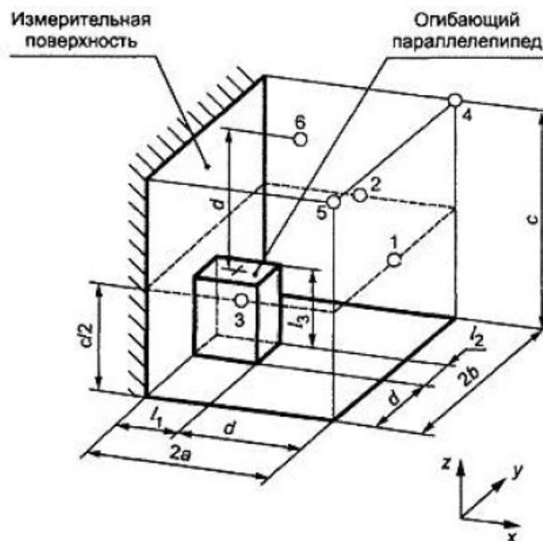
Рис. 2. Измерительная поверхность (параллелепипед) с шестью точками измерения для усложненного и полу у стены источник шум
