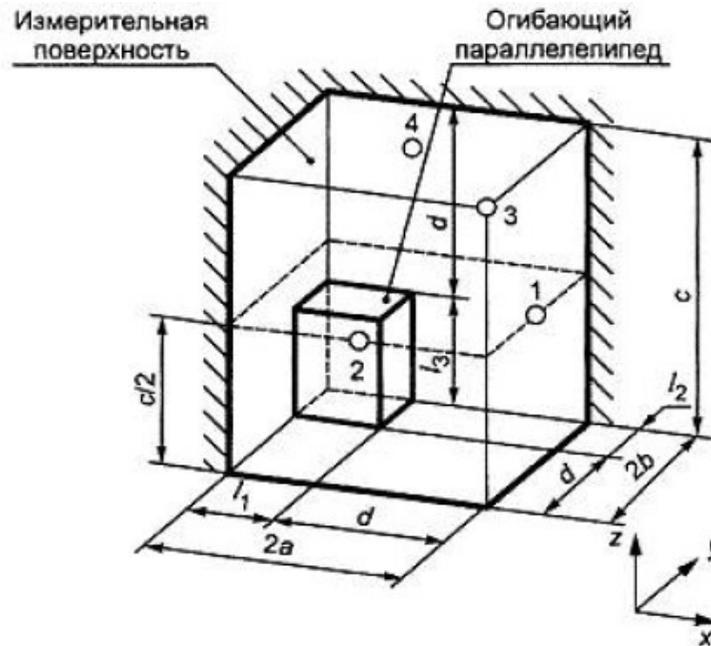
Рис. 3. Измерительная поверхность для источника шума, установленного в углу, с четырьмя точками измерения
