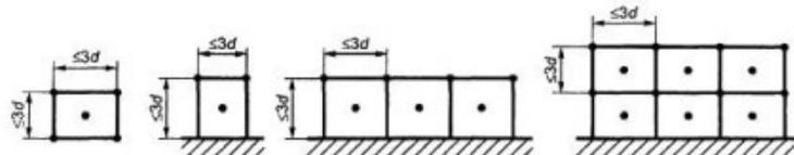
Илл. 2. Схемы определения положений точек измерения, когда ребро измерительной поверхности превышает  $3d$
