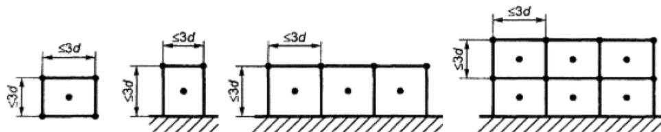
Рис. 4. Схемы определения положений точек измерения, когда ребро измерительной поверхности превышает  $3d$
