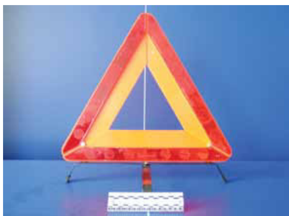
Иллюстрация 3. Знак № 3 – производитель неизвестен, имеет знак официального утверждения «E11 27R033910».
