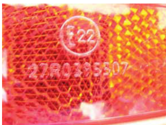
Иллюстрация 6. Знак официального утверждения знака № 4. «E22 27R0395507», E22 – отличительный номер страны, предст вившей официальное утверждение (Российская Федерация), 27 – номер Пр вил ЕЭК ООН (№27), 0395507 – номер официального утверждения.
