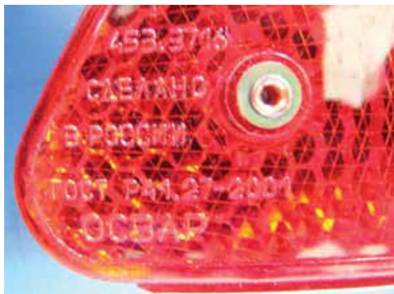
Иллюстрация 7. Маркировка знака № 4 – производитель ОСАВА, «Сделано в России», «453.3716» и «ГОСТ Р 41.27-2001».
