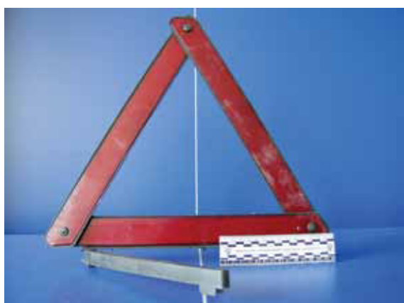
Иллюстрация 2. Знак № 2 – производитель неизвестен, маркировочных данных и знака официального утверждения не имеет.
