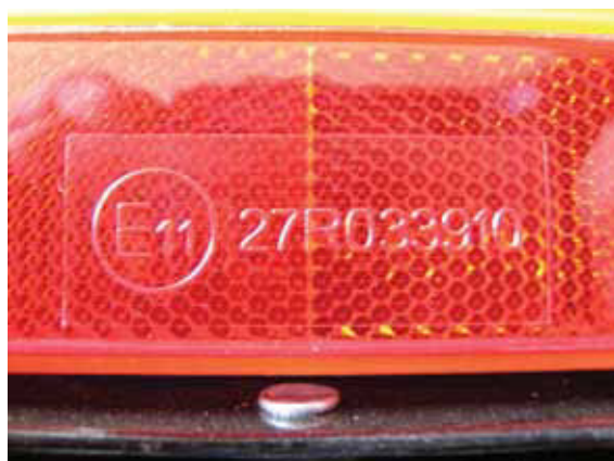
Иллюстрация 4. Знак официального утверждения знака № 3. «E11 27R033910», E11 – отличительный номер страны, предст вившей официальное утверждение
