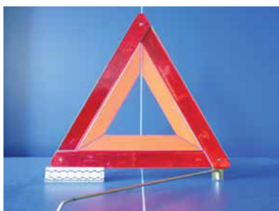
Иллюстрация 5. Знак № 4 – производитель ОС-ВАР, имеет знак официального утверждения «E22 27R0395507».
