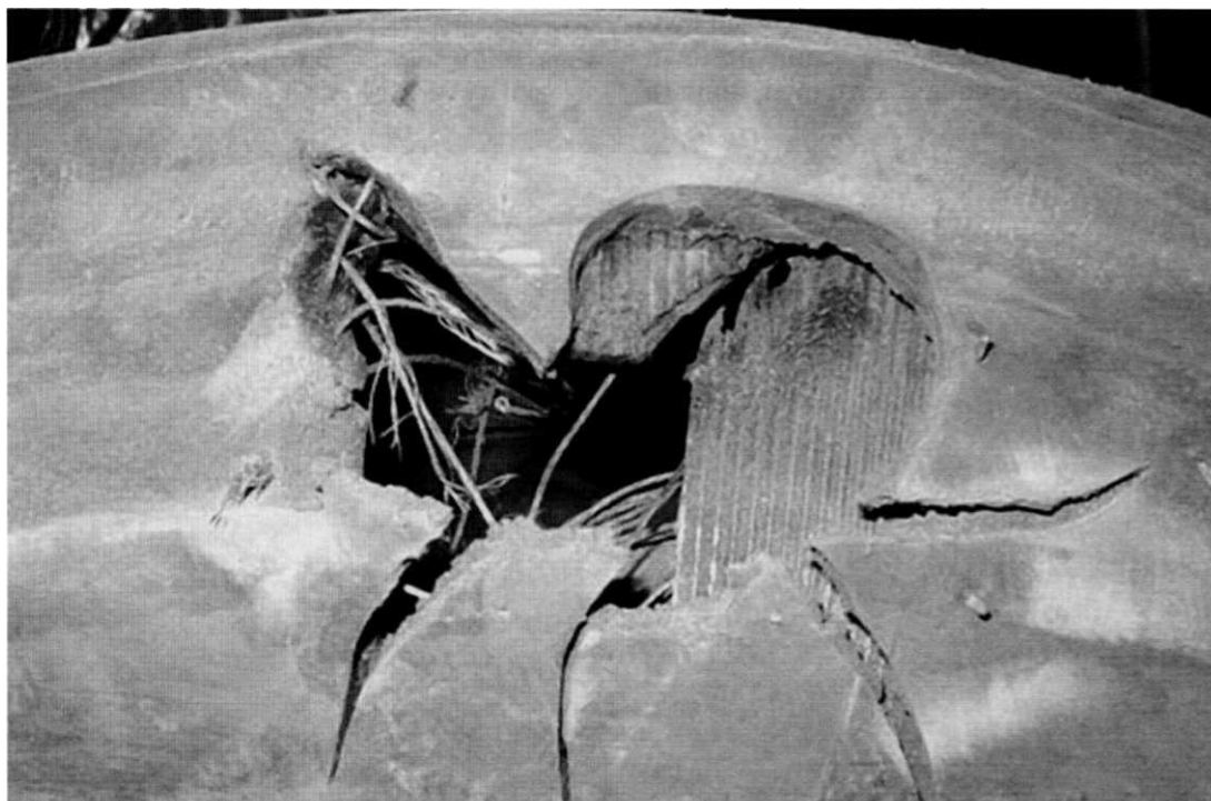
Рис. 23. Разрушение по типу «пневматический взрыв» бескамерной шины
