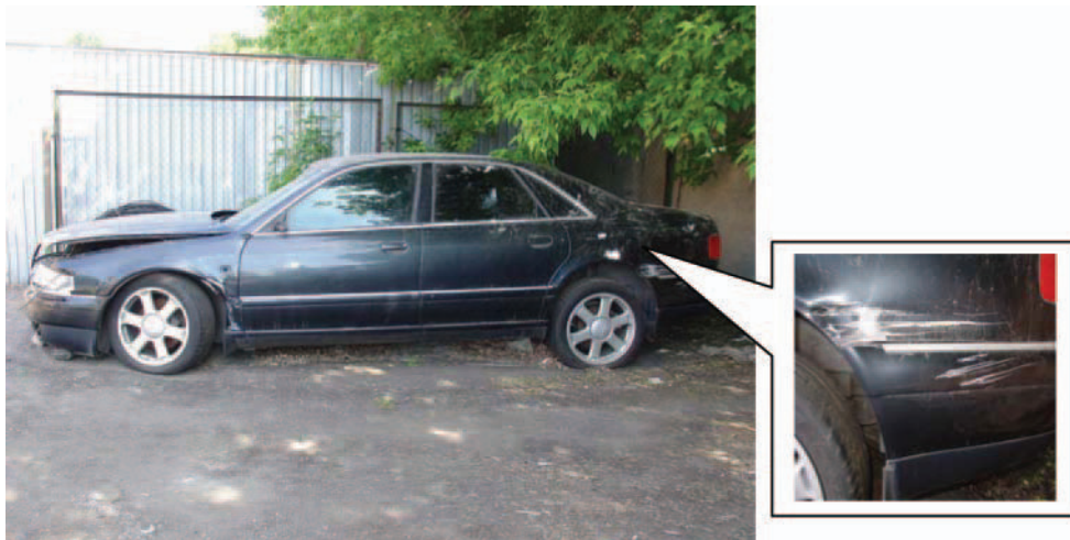
Фото 6. Повреждения, полученные автомобилем при косом столкновении.
