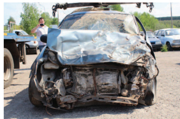
Фото 5. Повреждения автомобиля, полученные при блокирующем столкновении.
