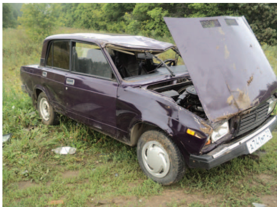
Фото 7. Повреждения панели крыши автомобиля, полученные при опрокидывании.
