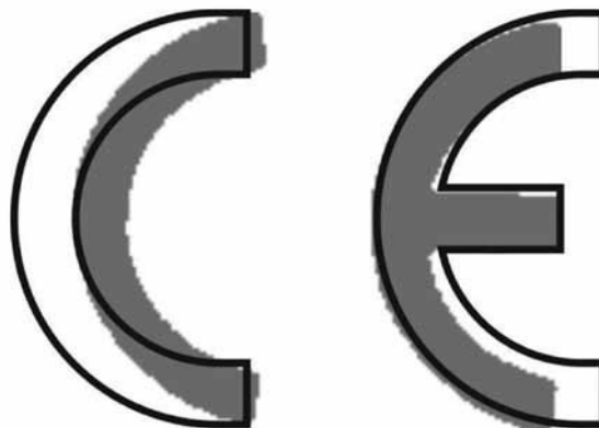
Рис. 2. Совмещение изображений маркировки CE на вентиляторе Verloni (показано темным цветом) с эталонным изображением по Решению Совета Европы от 22 июля 1993 г. 93/465/ЕЭС [1] (показано контуром)
