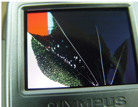
Рис.3. Внешний вид системы трещин в ЖК дисплее.
