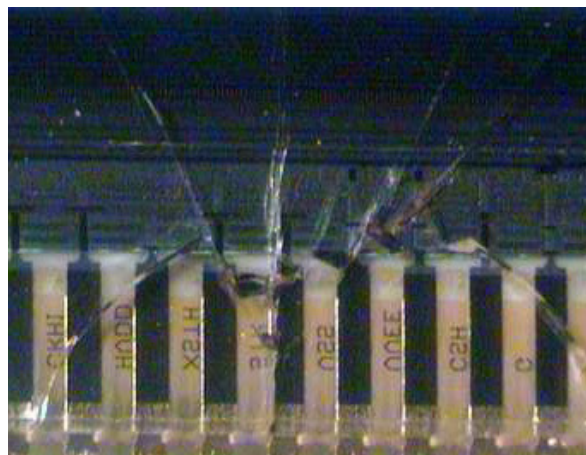
Рис.4. Место разветвления трещины (рис.3) на контактной площадке нижней пластины дисплея.
