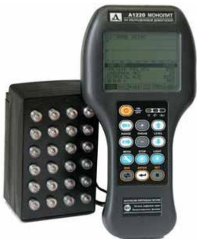
Рис. 2. Ультразвуковой дефектоскоп A1220 МОНОЛИТ
